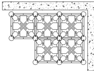
③ Den NEUEN ELEVETOR TANK installieren und dabei sicherstellen, dass die Verbindungen richtig hergestellt wurden.
