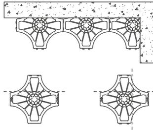
① Die Sockel wie im Schema abgebildet abschneiden und die erste Reihe ausrichten, indem sie an die Mauer gestützt wird. Mit der Ausrichtung von rechts nach links fortfahren.
