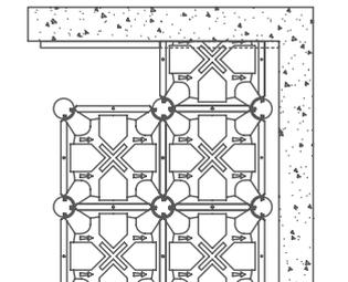
④ Ausrichtung der letzten Reihe von NEUER ELEVETOR TANK mit abgeschnittener Kuppel dicht an der Begrenzung.
