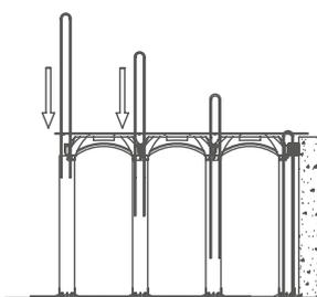
⑥ Das Gitter aus Baustahlgewebe und die zusätzlichen Bewehrungselemente in die Säulen einsetzen.
