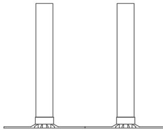
② Die Rohre aus PVC in die Sockel einsetzen und dabei Druck auf den oberen Teil der Rohre ausüben, sodass eine perfekte Verbindung hergestellt wird.
