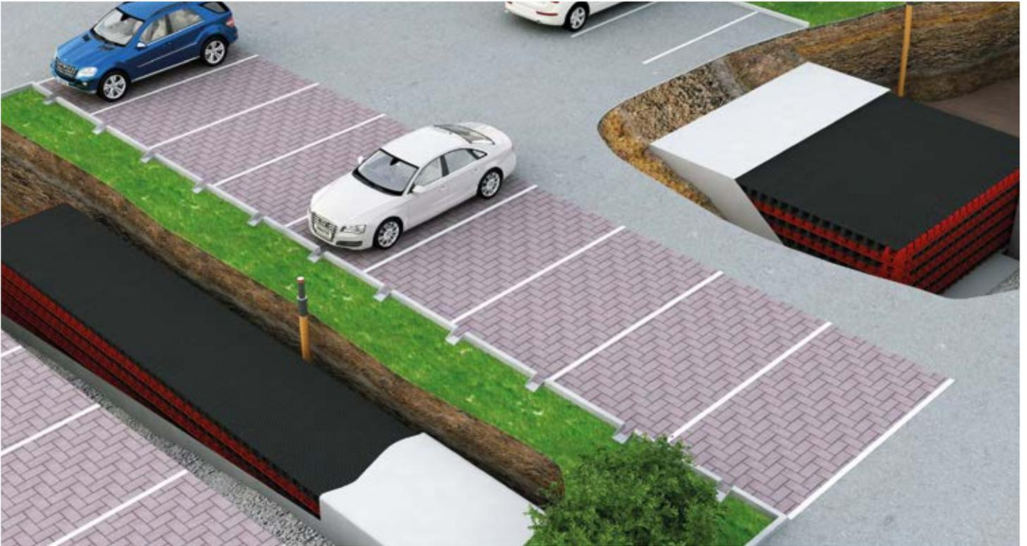
Modulares, besonders strapazierfähiges System zur Errichtung von drainierenden Becken oder Sammelbecken mit großem Fassungsvermögen.
