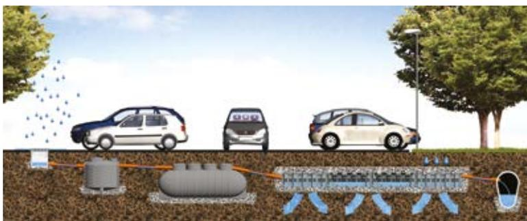
DRENING ist nicht nur eine Maßnahme, um Überschwemmungen vorzubeugen, sondern durch die Tatsache, dass es das Einsickern des Wassers in den Untergrund begünstigt, wird es zu einem System, das zur Wiederbefüllung von Grundwasserleitern beiträgt, die als eine der vom Mensch am meisten genutzten Wasserversorgungsquellen gelten. So wird das natürliche Wassergleichgewicht, das durch die wasserdichte Schicht im Boden gestört wird, aufrechterhalten.
