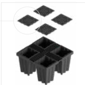
Der obere Abschluss ist ein universelles Verschlusselement für Aquabox- sowie für Aquabox Cube Module und wird nur auf der obersten Ebene der Rigole installiert. Beim Aquabox Cube wird das Modul mit 4 Kreissegmentkappen verschlossen.
