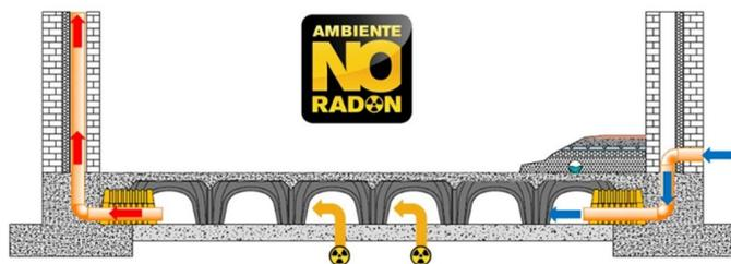
Hier die Lösung mit MODULO von Geoplast, ist eine Einwegschalung für den Bau von belüfteten Bodenplatten, die eine physische Trennung zwischen dem Boden und dem Gebäude herstellt. Dank der natürlichen Belüftung wird die aufsteigende Feuchtigkeit eliminiert und die Konzentration von **RADONGAS** im Gebäude verhindert.
