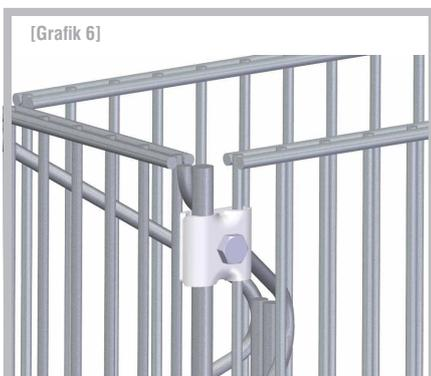
Vor dem Anbringen der Gittermatten muss der Fundamentbeton erhärtet sein! Die Gittermatten folgen mit dem Boden abschließen. Die Befestigung erfolgt mittels Universalklemmen (handfest anziehen) [Grafik 9].
